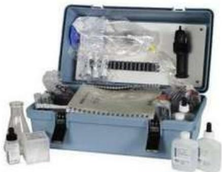
KIT DE PRUEBA DISEÑADO PARA AGUA DULCE UTILIZA REACTIVOS EN CARTUCHOS DESECHABLES DE FÁCIL LECTURA DIGITAL. ACIDEZ, ALCALINIDAD, DE 100 A 4,000 MG/L; AMONIACO: DE 0 A 3 MG/L; DIÓXIDO DE CARBONO: 10 A 100 MG/L; CLORURO: DE 10 A 160 MG/L, OXÍGENO DISUELTO: 0 A 10 MG/L; DUREZA DE 100 A 4,000 MG/L; NITRITOS: 0 A 0.5 MG/L; PH DE 4 A 10; TEMPERATURA: -30 A 120 °F. PESA 6 KG.
