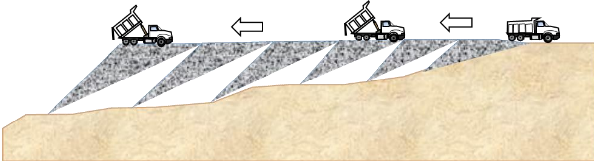
Figura II-10. Representación gráfica del vaciado en forma de cascada sistemática para la disposición del suelo estéril (tepetate).
