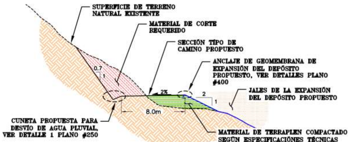
Figura II-6. Sección tipo del camino propuesto
