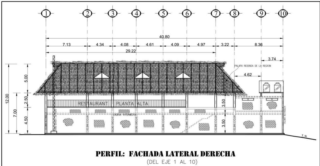
Figura 8. Perfil fachada lateral derecha.
