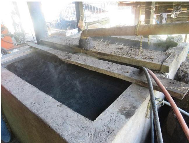
Foto 22. Por condensación del serpentín se precipita el producto.
