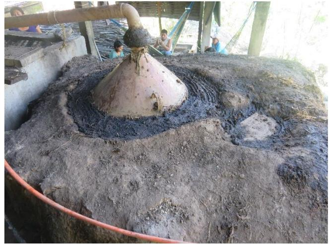
Foto 21. El proceso de horneado se hace en cocinas rusticas, y a través de serpentín se recuperan los vapores.
