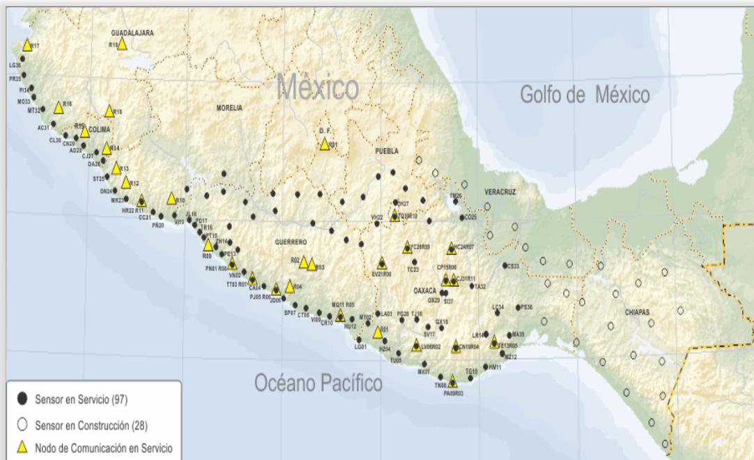
Imagen 24 Red del sistema de alerta sísmico de México
