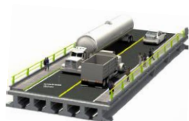
Imagen 33. Partes representativas de la subestructura de Puente, tomado de la Guía de exploración y elaboración de estudios y proyectos para la cimentación de puentes, SCT 2014.
