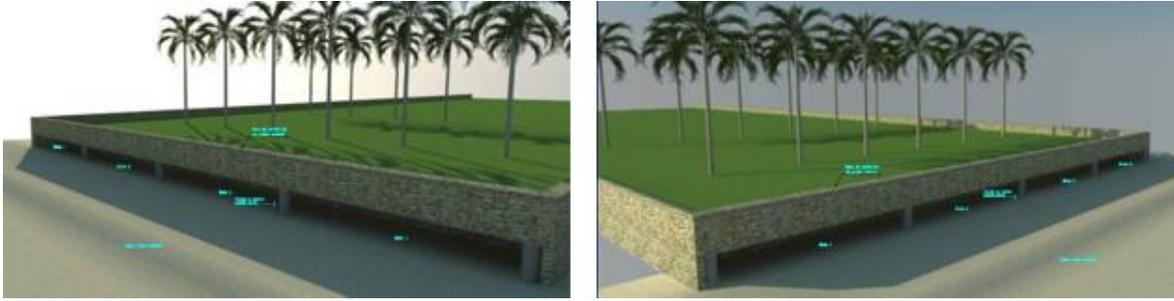
La altura del proyecto a partir del nivel de suelo arenoso será de 2.15 metros, tendiendo un espacio de un metro de altura para la anidación de tortuga marina, posteriormente una losa de 20 cms. de espesor y un muro delantero de 95 cms. de altura, como se observa en la siguiente figura:
