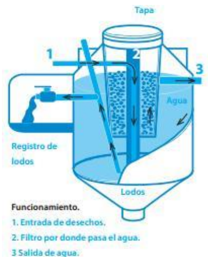
Figura II.11 Funcionamiento Biodigestor Rotoplas
