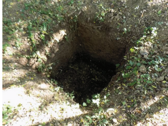
FIGURA IV. 16 POZO REALIZADO PARA ESTUDIO PREELIMINAR DE MECANICA DE SUELOS
