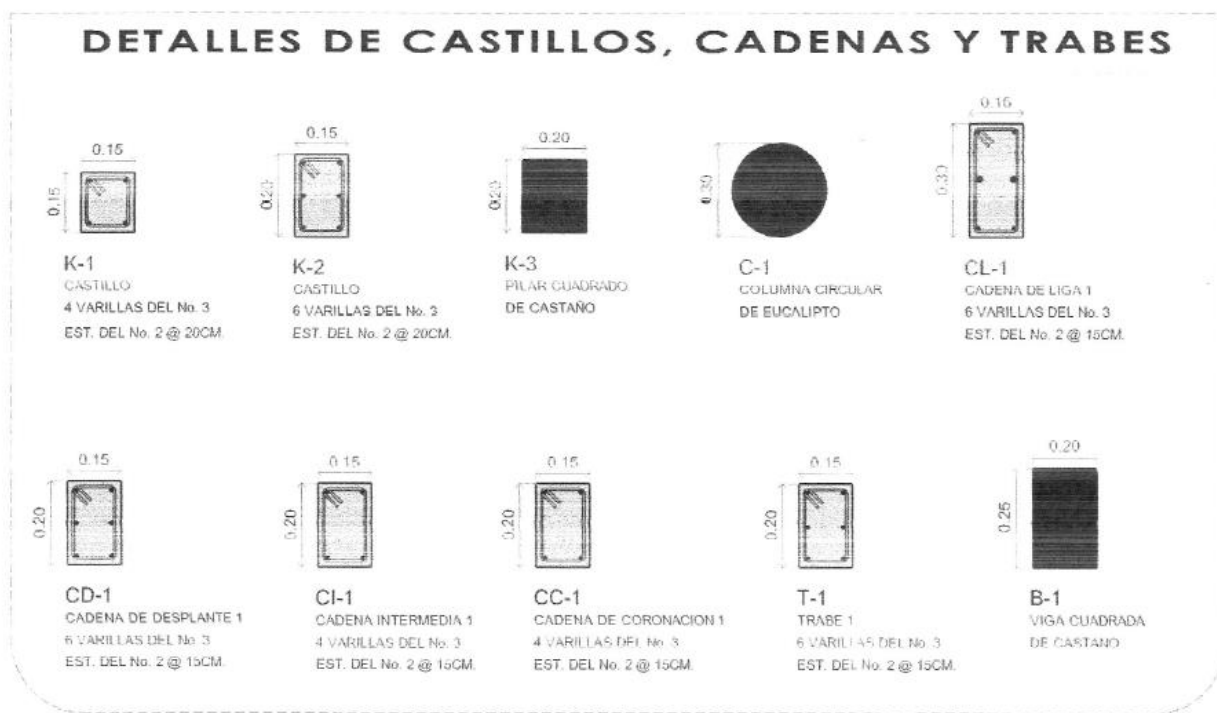
Figura 6 Detalles de castillos, cadenas y trabes
