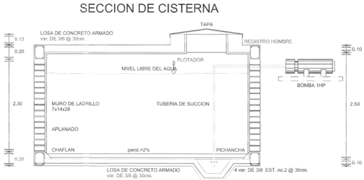
Figura 5 Sección de cisterna
