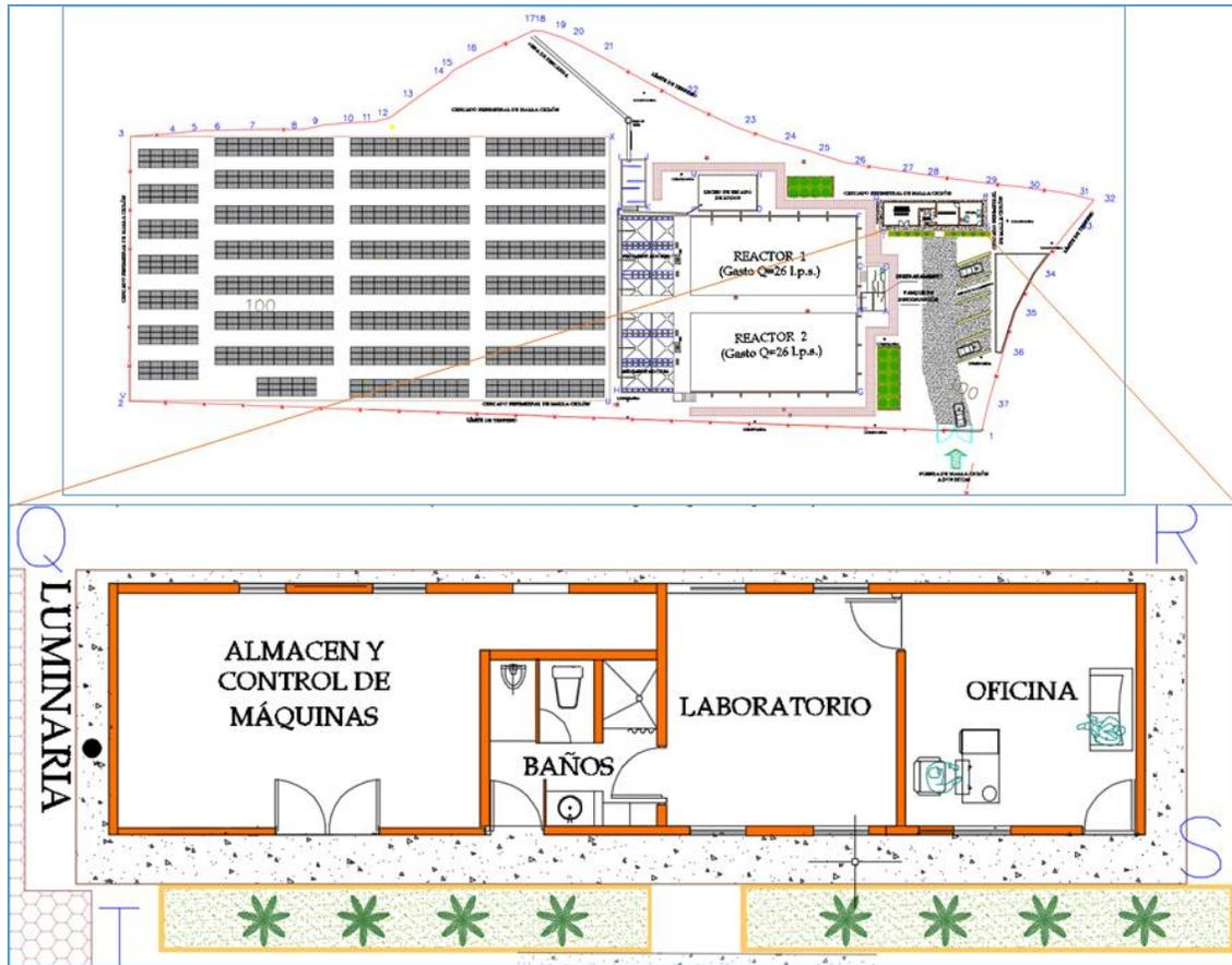
Figura 0-8 Planta arquitectónica del almacén y control de máquinas , Baños, Laboratorio y Oficina en un área de 100 M<sup>2</sup>
