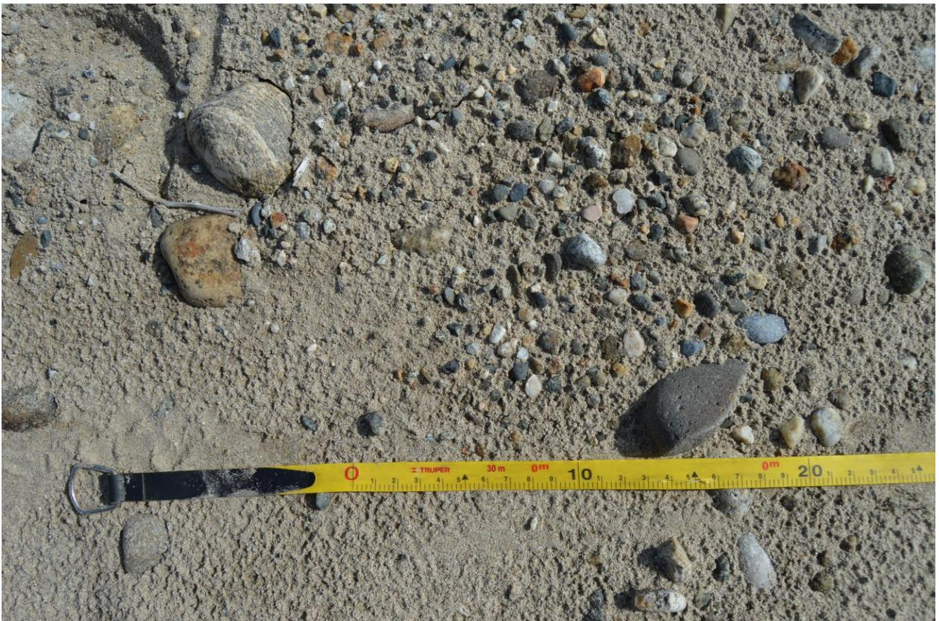
Imagen 17. *Material aluvial en el cauce del Río Copalita en el sitio del proyecto.*
