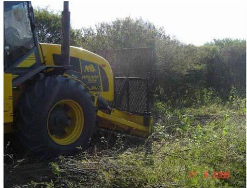
El material producto del despalme se procurará destinar para la formación de los accesos, compensar sitios u oquedades afectadas por la erosión, para ello se simulará el relieve original, primero se colocarán las rocas mayores y después el material más fino, posteriormente se arropará con el material de despalme y se reforestará.
