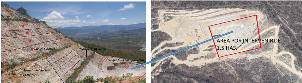
Ilustración II-6. Área por aprovechar en una superficie de 1.5 Has. Considerando una terraza de 10 metros con altura de 12 metros en 3 años con un volumen de 18,000.00 m<sup>3</sup>
