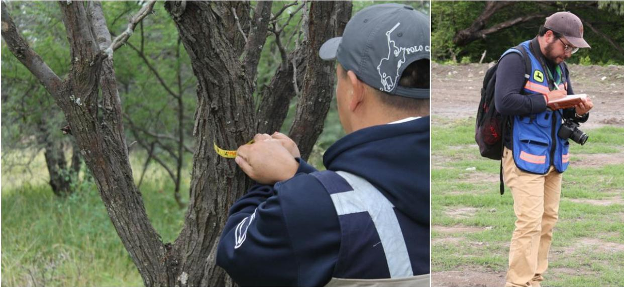
Imagen 24. Medición y registro de especies dentro de la parcela de 400 m<sup>2</sup>; medición de diámetros, obtención de alturas y conteo de individuos y especies.
