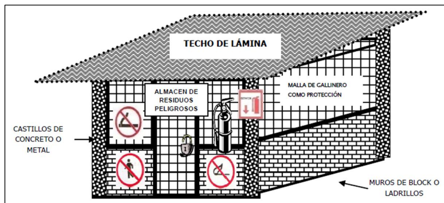
Figura 2.13. Características del almacén de residuos y sustancias peligrosas.
