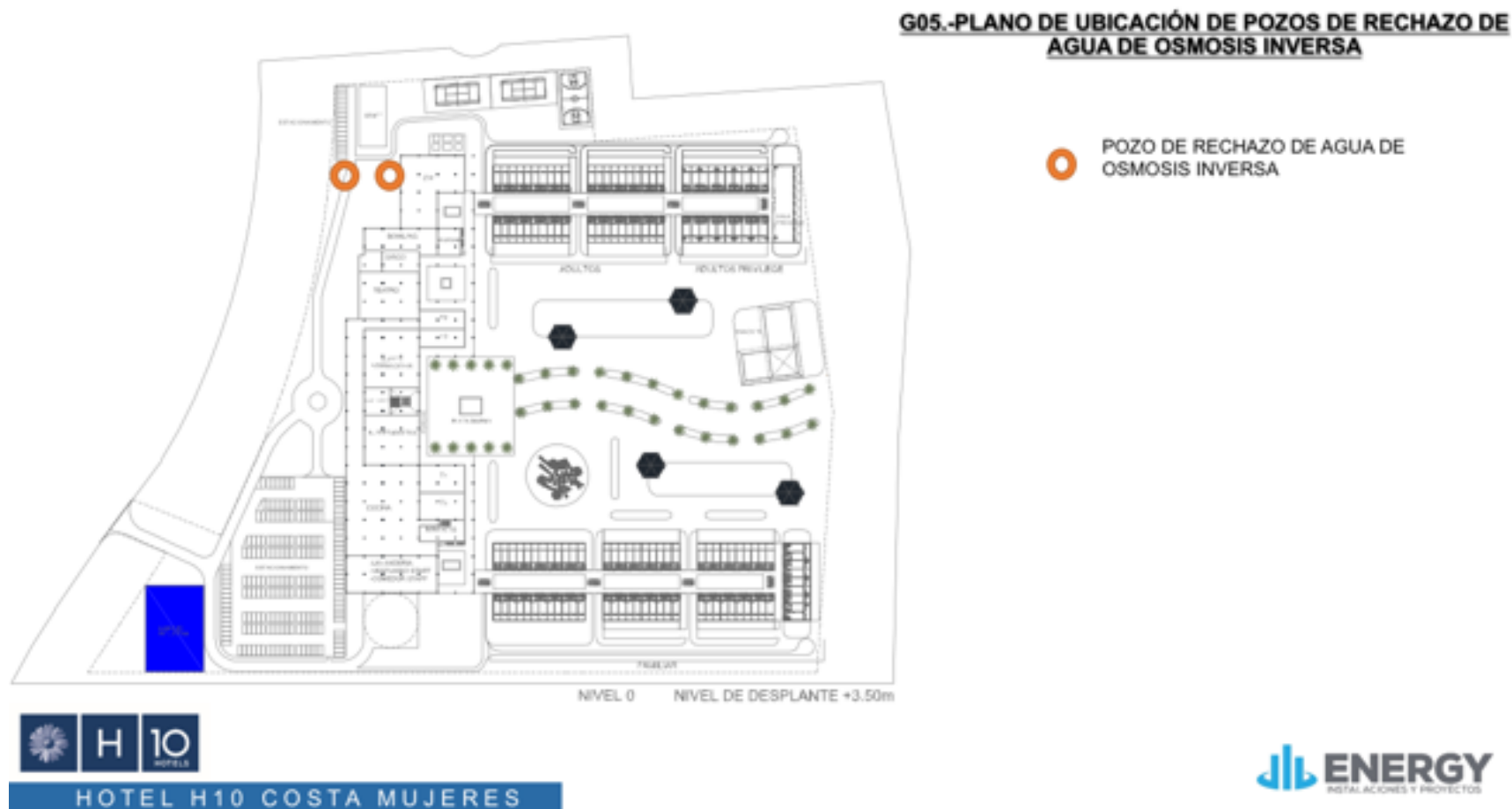
Imagen II-10. Ubicación de los dos pozos de rechazo de agua para ósmosis inversa.
