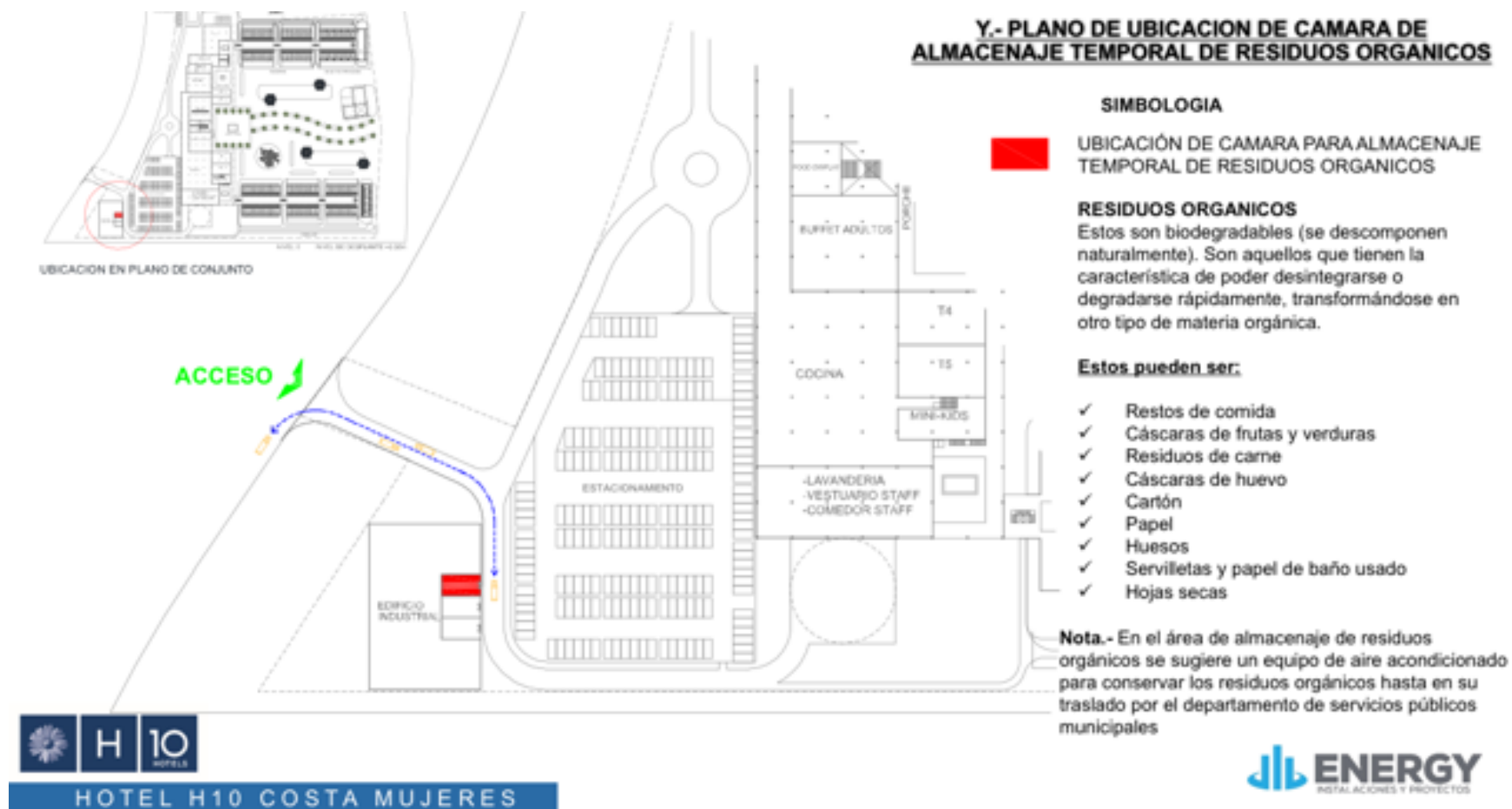
Imagen II-17. Ubicación de la cámara de basura orgánica del hotel en operación.
