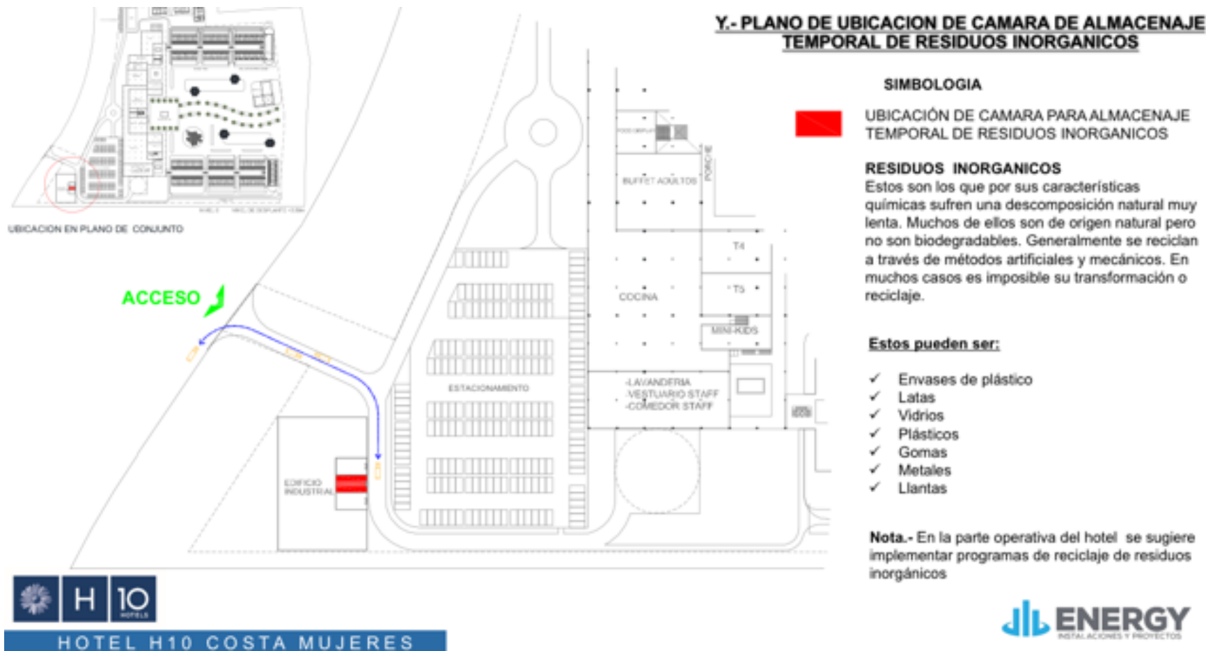
Imagen II-18. Ubicación de la cámara de basura inorgánica del hotel en operación.
