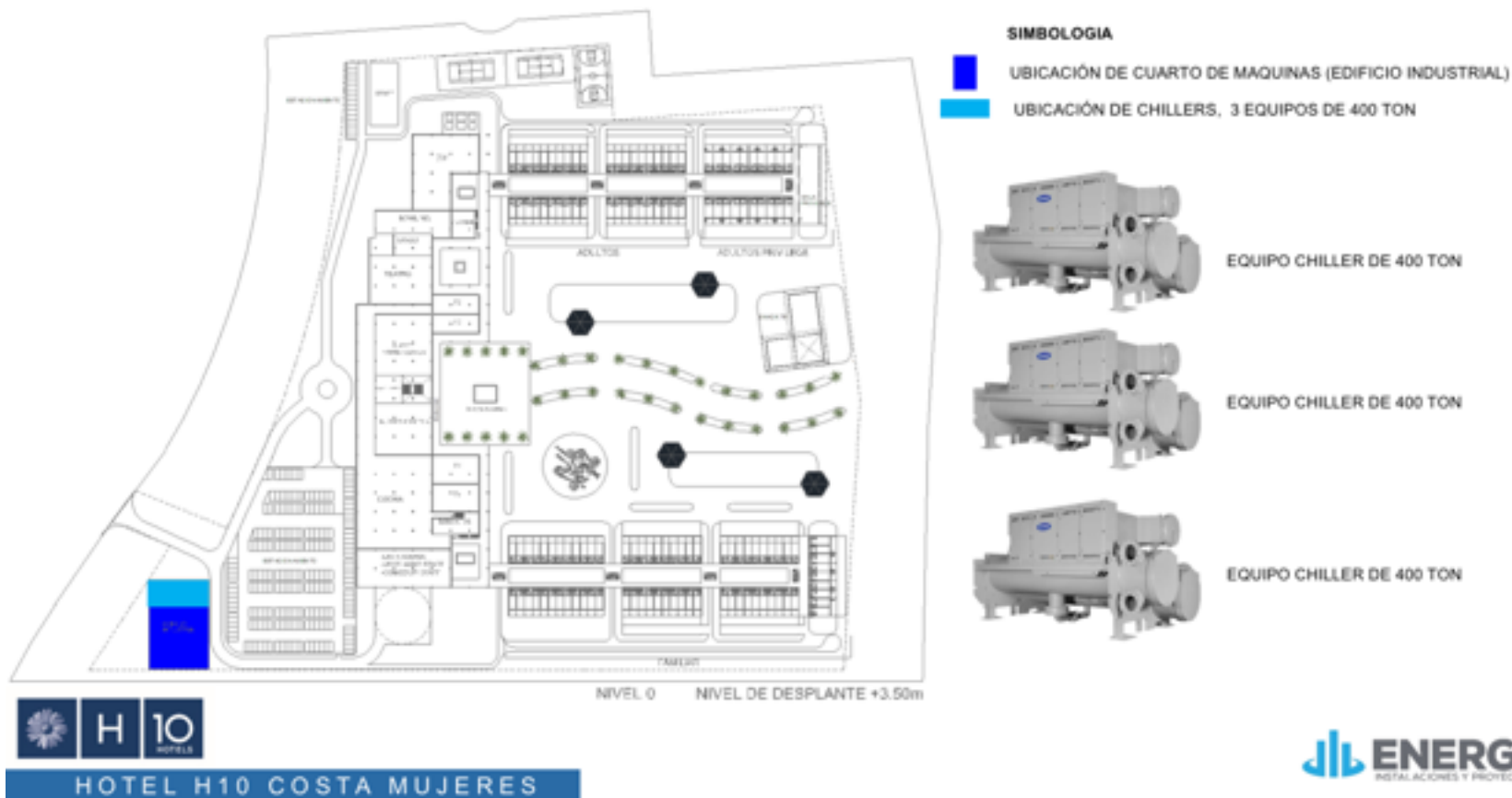
Imagen II-13. Ubicación de los chillers, en el edificio industrial.
