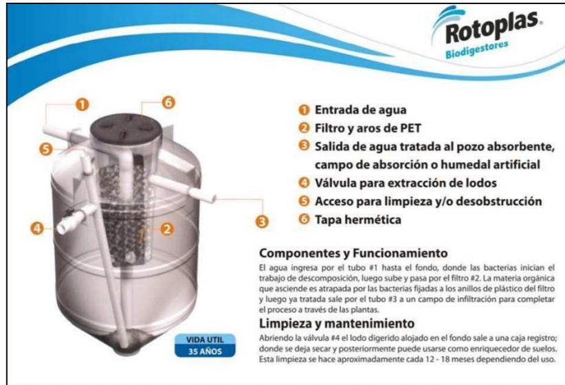
**Figura 2.18** Esquemización de los componentes de los biodigestores.
