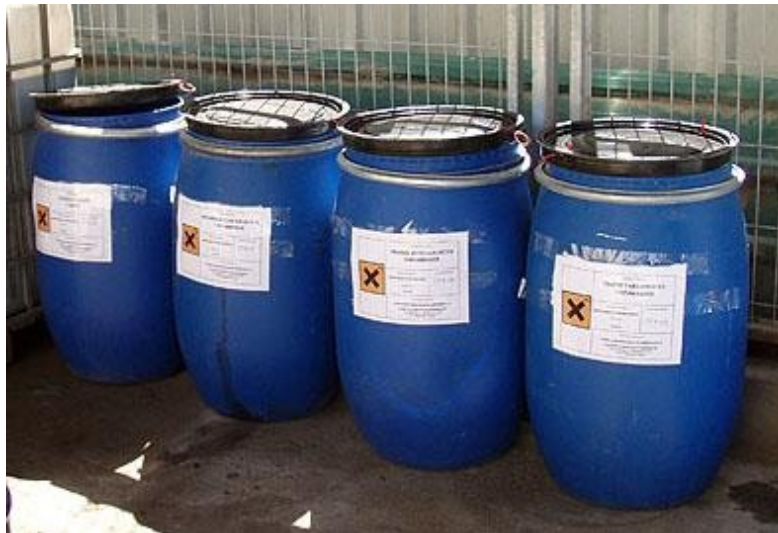
Fig. 40.- Ejemplo de botes y señalización tipo a utilizar en la etapa operativa del proyecto para el confinamiento temporal de residuos que por su naturaleza se consideren como peligrosos.
