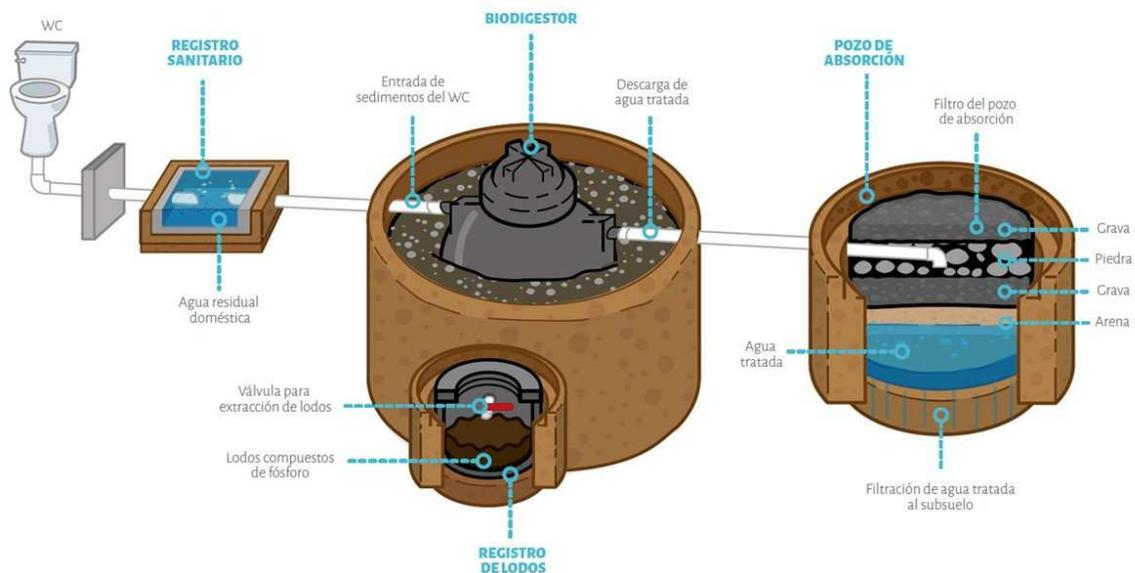
Figura 7 instalación del biodigestor para el proyecto Casa Arroyo
