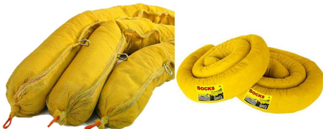
**Descripción.-** Son mangas de polipropileno rellenas de fibras orgánicas naturales, ideales para ser utilizadas en derrames de hidrocarburos en forma cilíndrica de 250 cm de largo con un diámetro de 10 cm, cuyo peso aproximado es de 2.2 kg.
