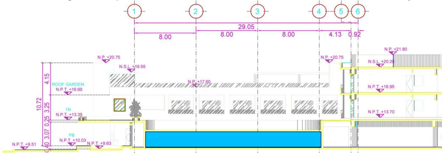
Figura 11. Se presenta un corte donde se muestra la cisterna y el estacionamiento en planta baja y las habitaciones en segundo nivel.
