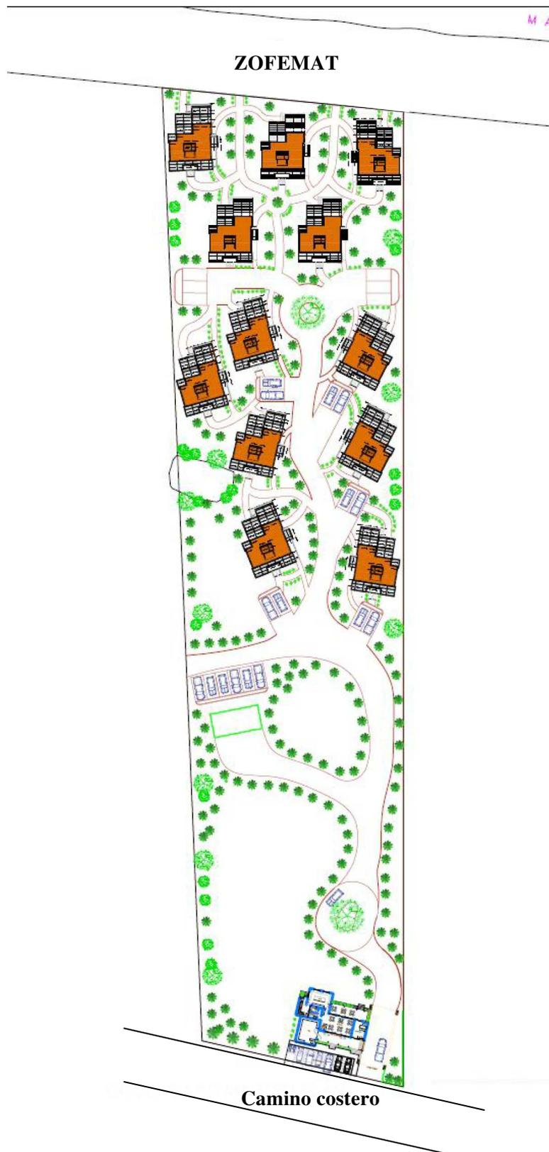
**Figura 13.-** Planta de conjunto del proyecto donde se observa la distribución de las obras que lo integran
