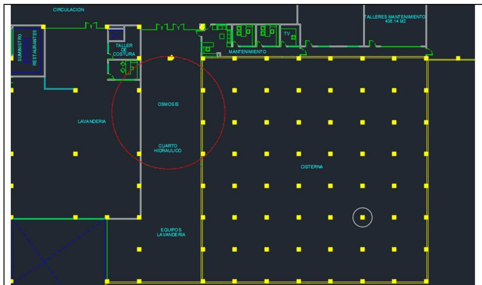
Figura 4.- Imagen en la cual se indica la ubicación de la sala de máquina (cuarto hidráulico) (círculos rojo), que albergara la planta de osmosis inversas.
