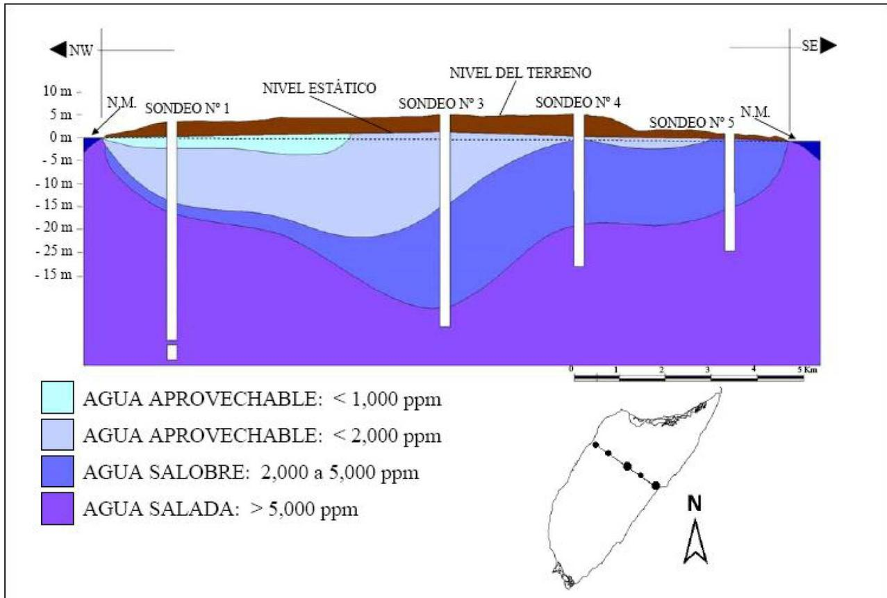
Figura 12.- Sección del acuífero de la Isla de Cozumel mediante el muestreo en 5 sondeos. Se observa como la capa de agua aprovechable de un máximo de 23m se localiza de forma desigual; presentando mayor grosor en el lado noroeste (Lesser et al., 1978). (Tomado de Estudio Previo Justificativo para el establecimiento del Área de protección de flora y fauna Isla de Cozumel, Quintana Roo, elaborado por CONANP, 2007.)
