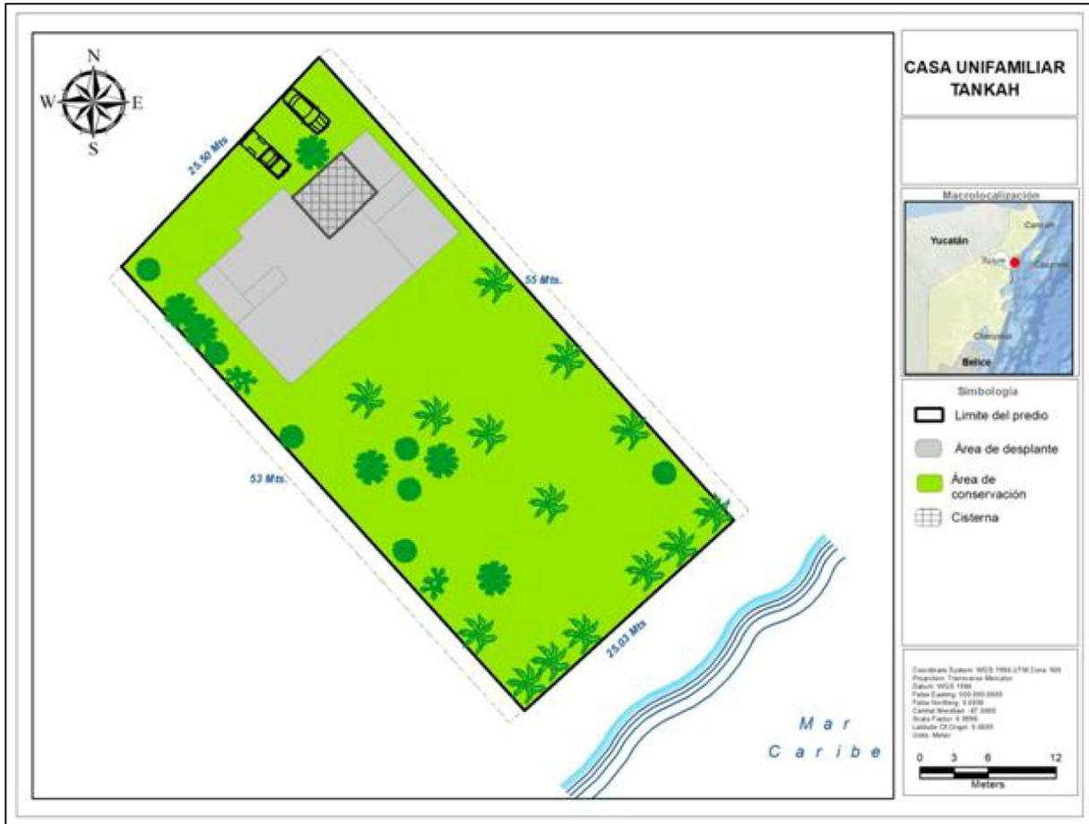
Imagen donde se observa la ubicación de la cisterna de almacenamiento de agua potable. Como se ha manifestado la construcción de la cisterna será debajo de la casa.
