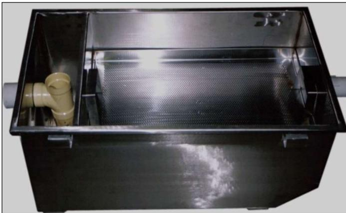
Fabricada totalmente en lámina de acero inoxidable calibre 18. Patas en el mismo material con tornillos de nivelación; tapa asegurada al cuerpo de la trampa por medio de broches de presión. Incluye una pieza de acero inoxidable, removible, para retener los sólidos y permitir el retiro de las grasas retenidas.
