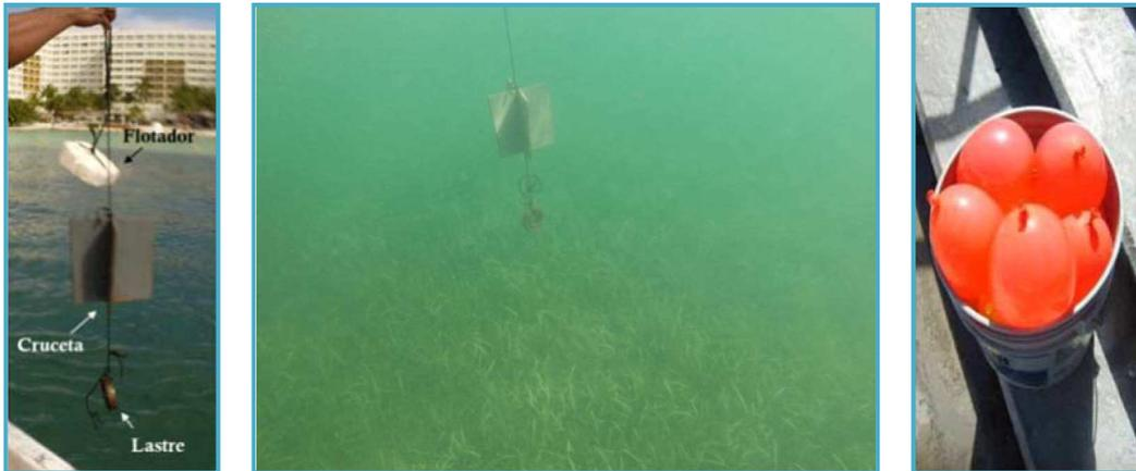
**Figura IV\_ 15.- Fotos de crucesas de deriva y globos rellenos con agua usados en las mediciones de las corrientes.**
