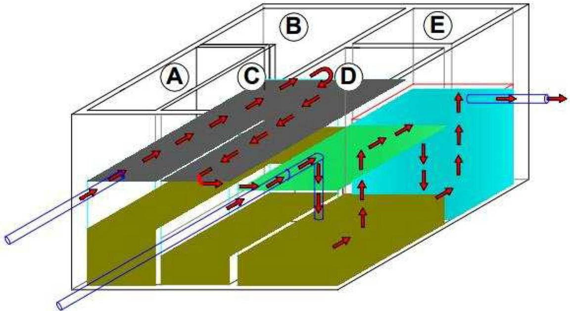
**Figura 2.12.** Esquema de funcionamiento de la microplanta.
