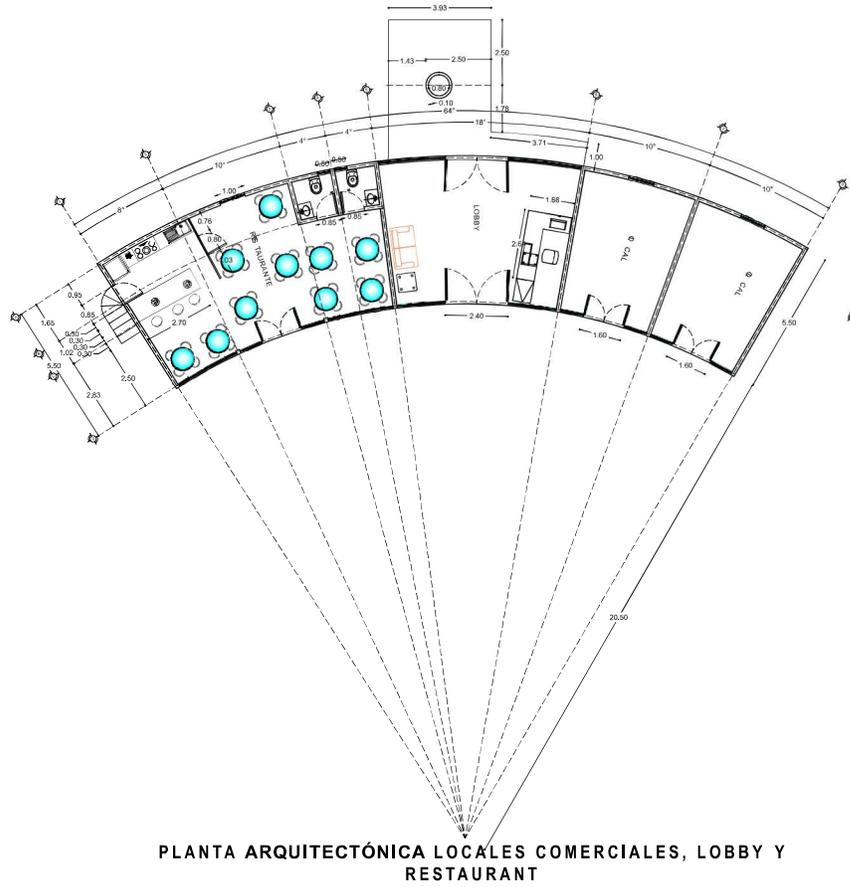
**Figura 2.8.** Planta arquitectónica de los locales.
