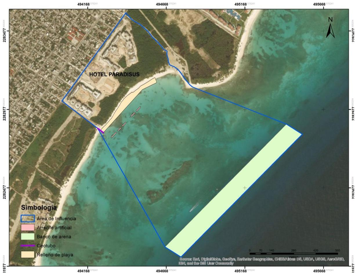
**Figura 2. Croquis de distribución de los elementos que conformarán el proyecto.**
