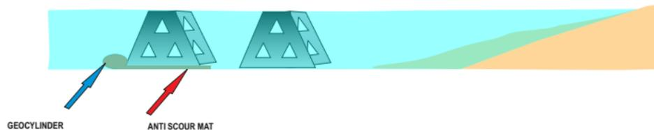
**Figura 8. Descripción esquemática de los AMA<sup>®</sup> y del anclaje que será utilizado**
