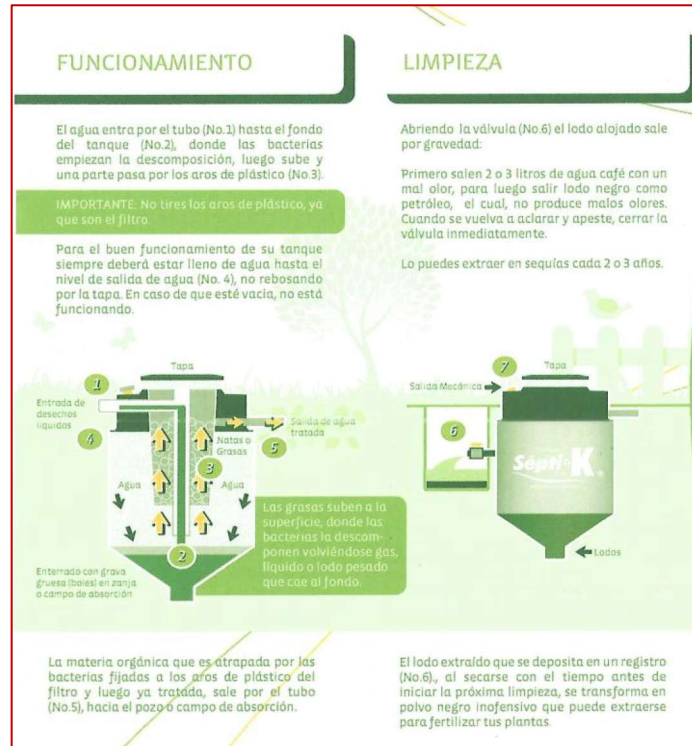
Figura 2.11. Funcionamiento y limpieza del biodigestor Tanque Biodigestor Clarificador Fosaplas de Rotoplas
