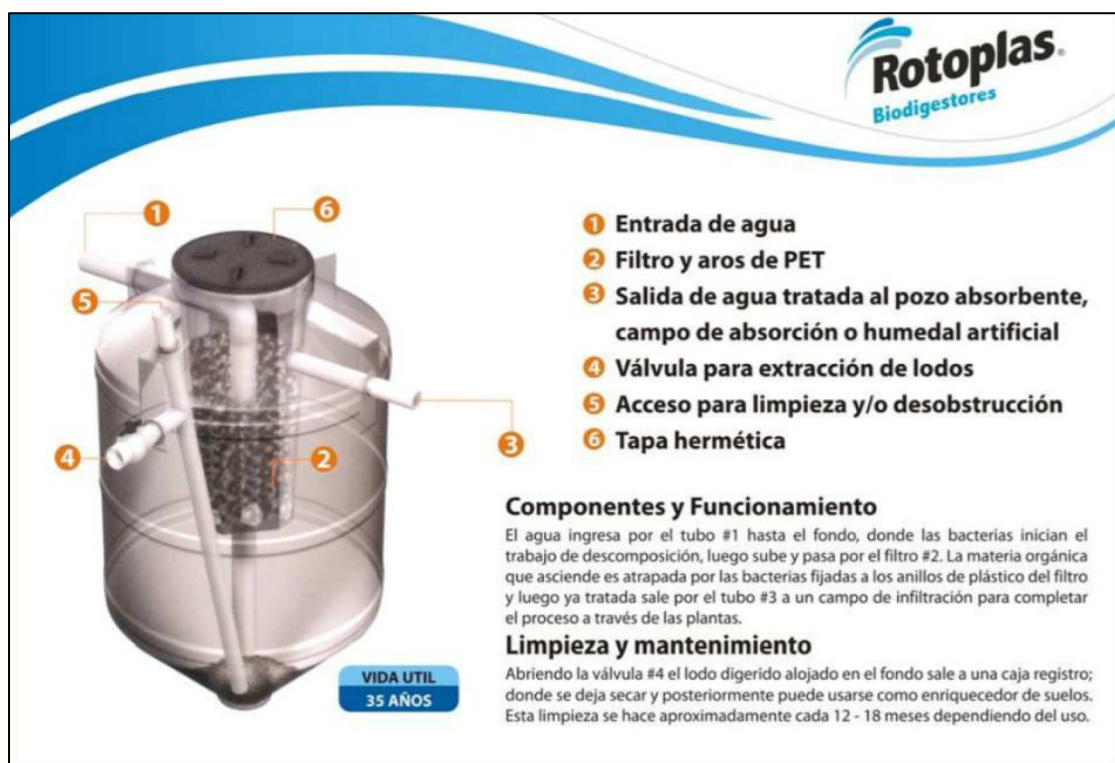
Figura 2.20. Biodigestor autolimpiable de la marca Rotoplas.
