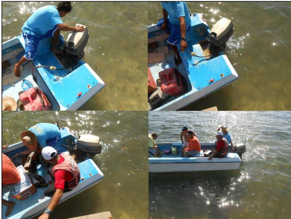
Ejemplo de Embarcación con motor fuera de borda y pata larga en funcionamiento en profundidad aproximada de 1 m, sin alterar el fondo marino (sedimento) ni la vegetación, el presente proyecto consta de profundidad de 1.10 m.
