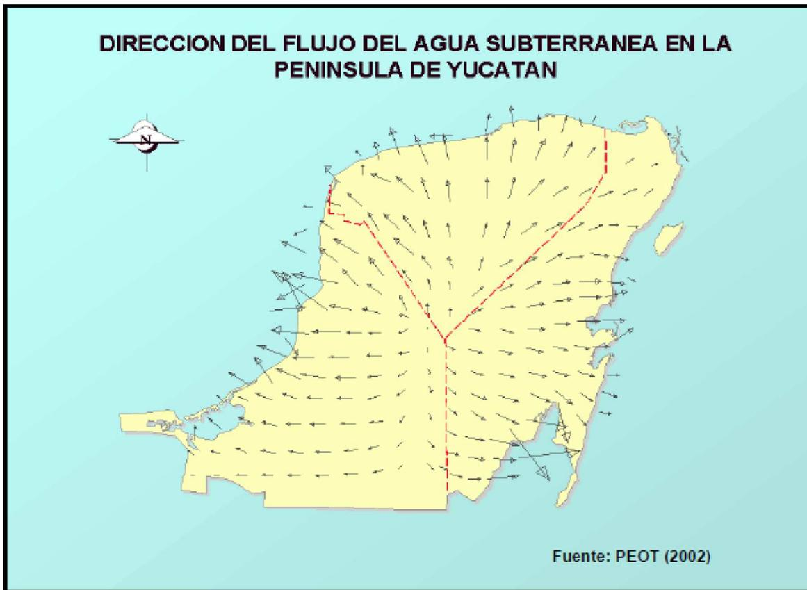
**Figura 44.** Dirección del flujo de agua subterránea. La dirección general del flujo subterráneo en la península es a partir de la parte más alta que se localiza en la sección central de la misma, hacia el Oriente, Sur, Norte y poniente con componentes hacia el Surtes, Noroeste y Noreste.
