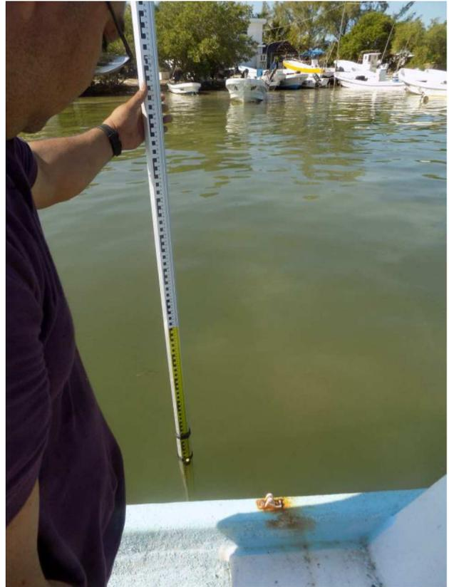
**Fig. 15.-** Proceso de toma de datos batimétricos
