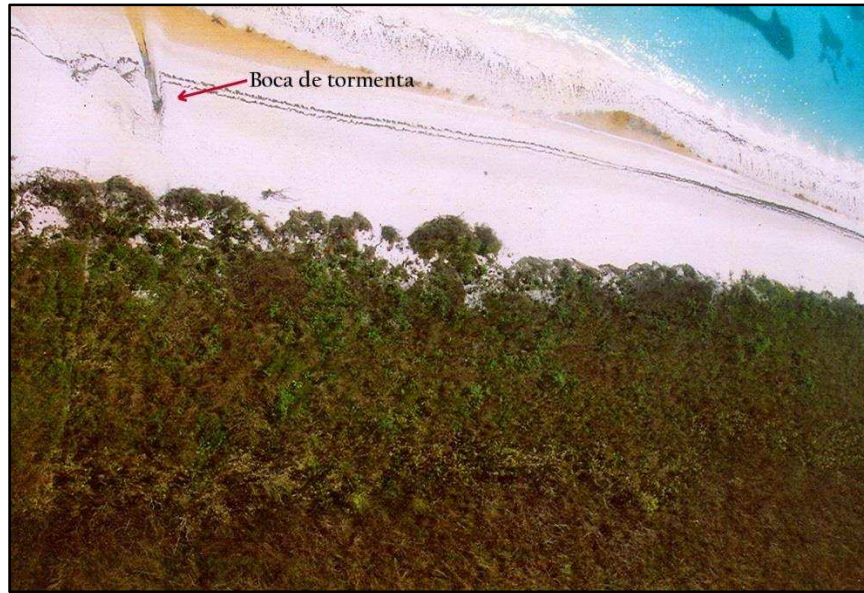
Ejemplo de una boca de tormenta temporal en la zona costera de puerto Morelos. Esta boca de tormenta es subterránea, ya que transcurre por debajo de la duna arenosa sin abrir una desembocadura de forma franca. Esta se formó después del paso del Huracán Wilma, con lo cual se desfogan hacia el mar las demasías que se han acumulado dentro de la cuenca, suministrando aportes de aguas dulces y nutrientes al Parque Marino Nacional.
