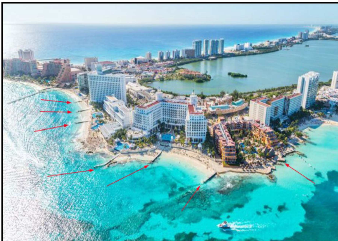
Figura 2 Estructuras de protección costera que interrumpen el libre tránsito del sedimento (flechas rojas). Fuente: Planing Quintana Roo (2017).
