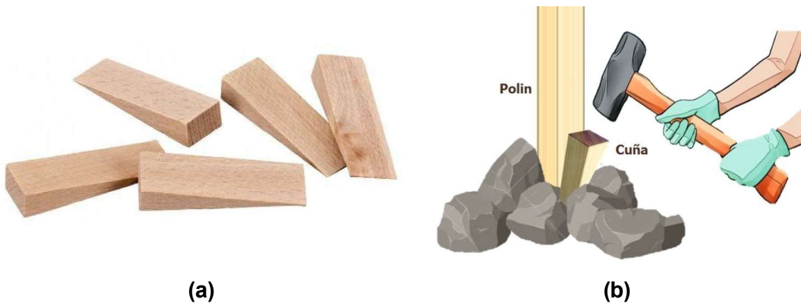
Figura 10. En (a), se aprecian las cuñas de madera que se usarán para calzarlos polines con la roca, y en (b), se aprecia la forma en que serán fijadas las cuñas y los polines.
