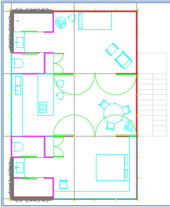
Img 9. Casa del gerente, este módulo será pilotado, constará de un solo espacio habitacional, sobre una superficie de 98.2 m 2 , de los cuales únicamente 9.4 m 2 son sellados.
