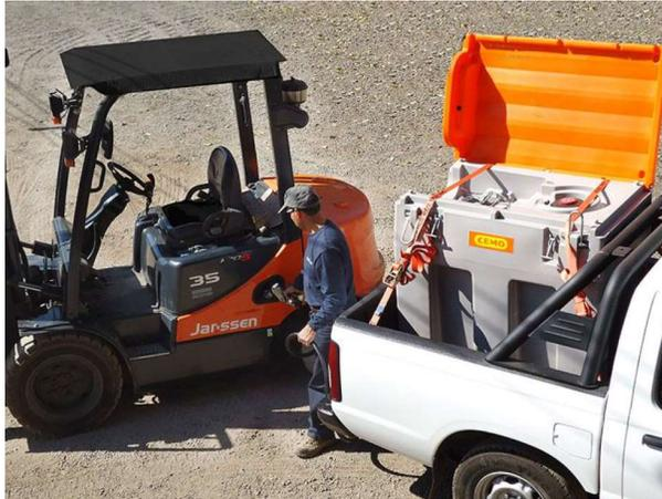
Imagen II.11.- ejemplo de vehículo con bomba de gasolina portable
