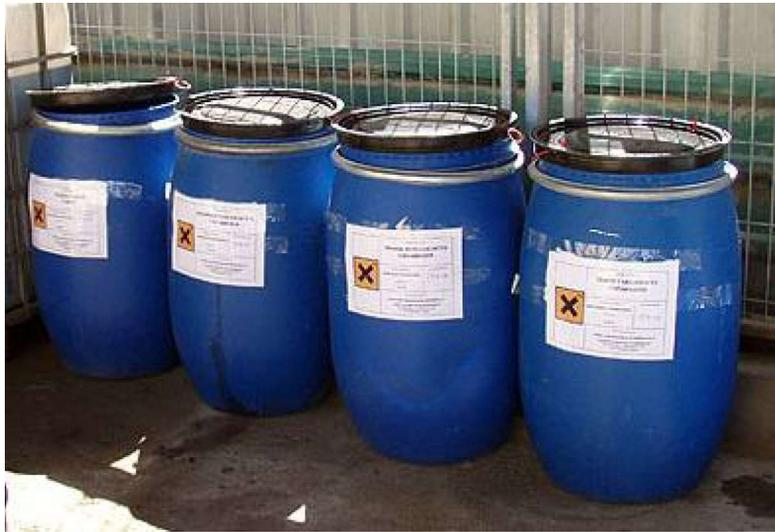
**Figura 48.-** Ejemplo de botes y señalización tipo a utilizar en la etapa operativa del proyecto para el confinamiento temporal de residuos que por su naturaleza se consideren como peligrosos.
