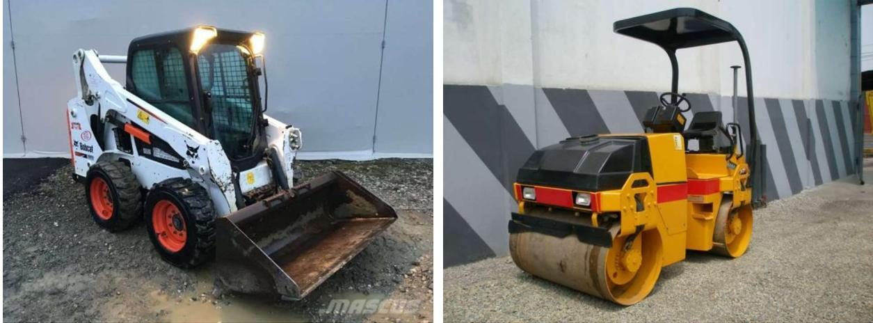
**Figura 10.-**Vistas de mini maquinaria pesada: Bobcat y mini aplanadora, que se utilizarán para los rellenos y nivelación de las plataformas escalonadas.
