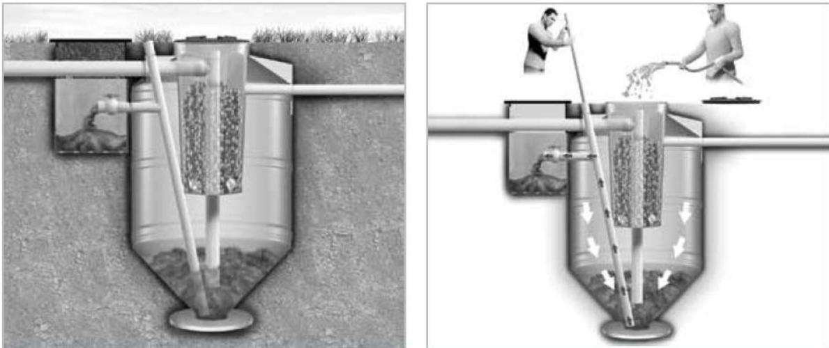
*Imagen 12 Mantenimiento del biodigestor.*
