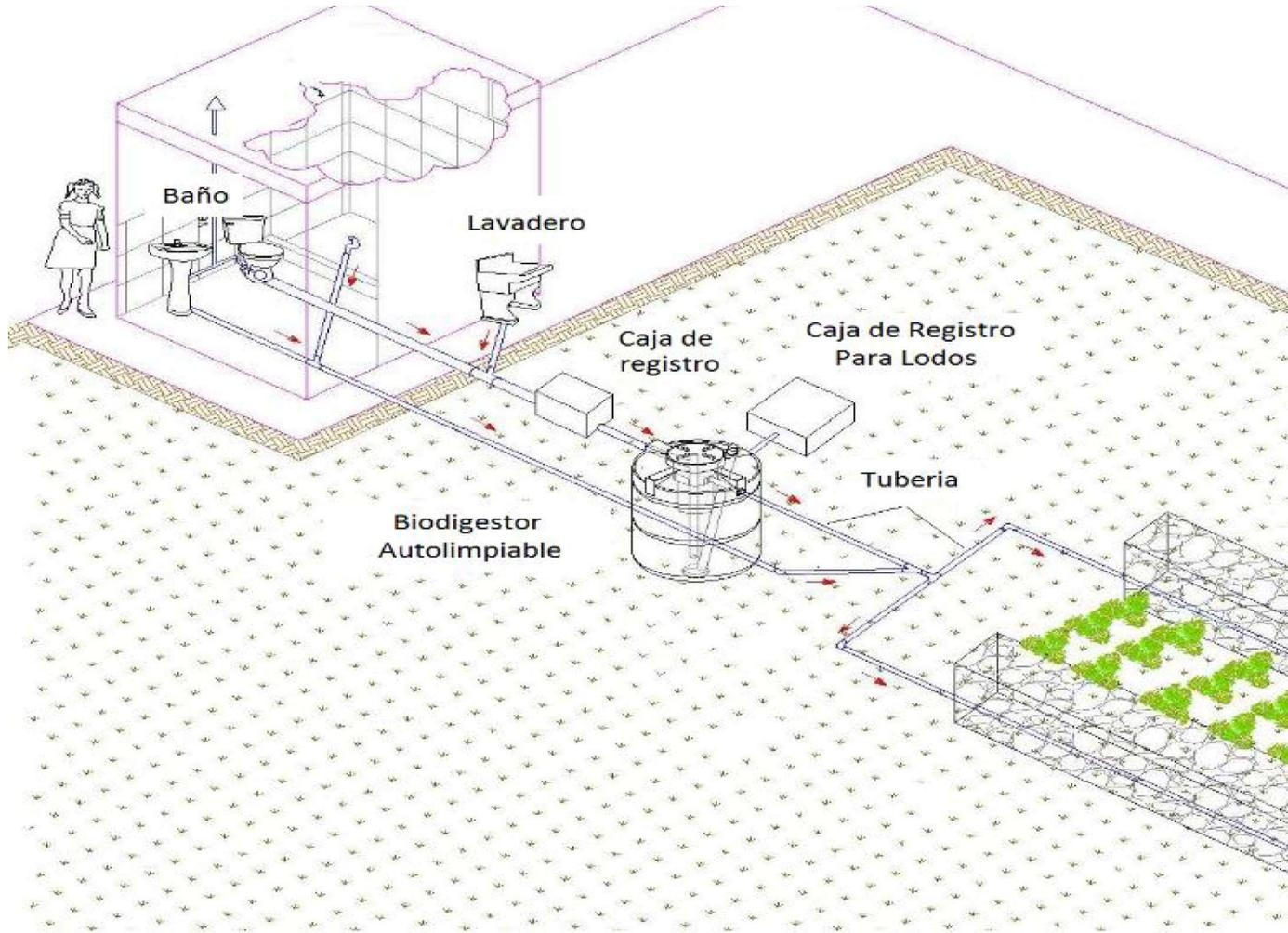
*Imagen 13 Esquema Representativo del proceso de tratamiento de aguas residuales.*
