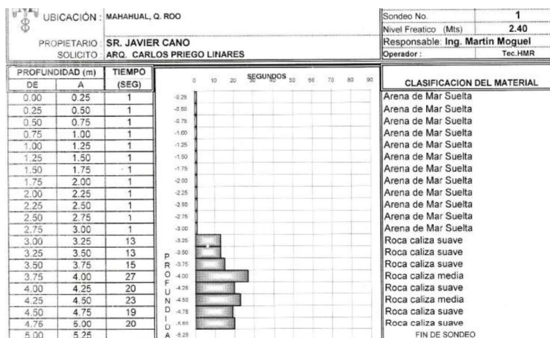
Figura 9.- Estratificación de los suelos presentes en los puntos explorados durante la caracterización de estabilidad del suelo
