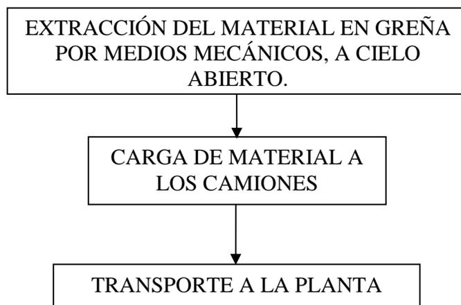
**EXTRACCIÓN:** La extracción del material en greña se realizará a través de una Excavadora CAT CX210B, con capacidad de 1 m<sup>3</sup>, modelo 2010.
