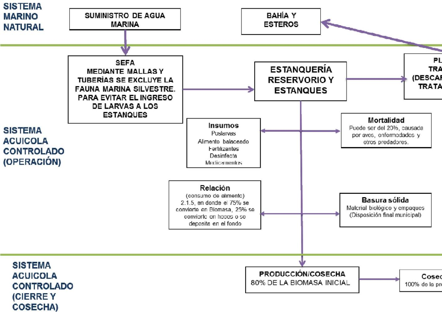
Figura VII.1 Diagrama de flujo del proyecto **con** medidas de Mitigación
