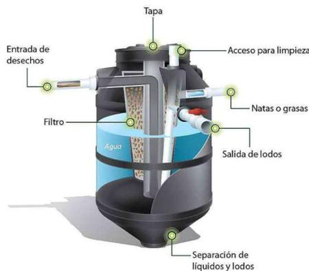
Figura 2.3 Biodigestor sugerido
