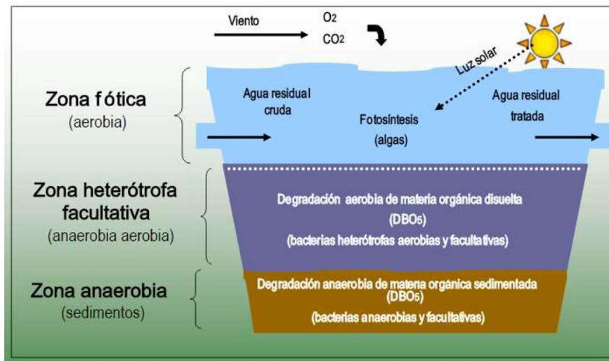
**Figura 6.4** Operación de la Laguna de Oxidación
