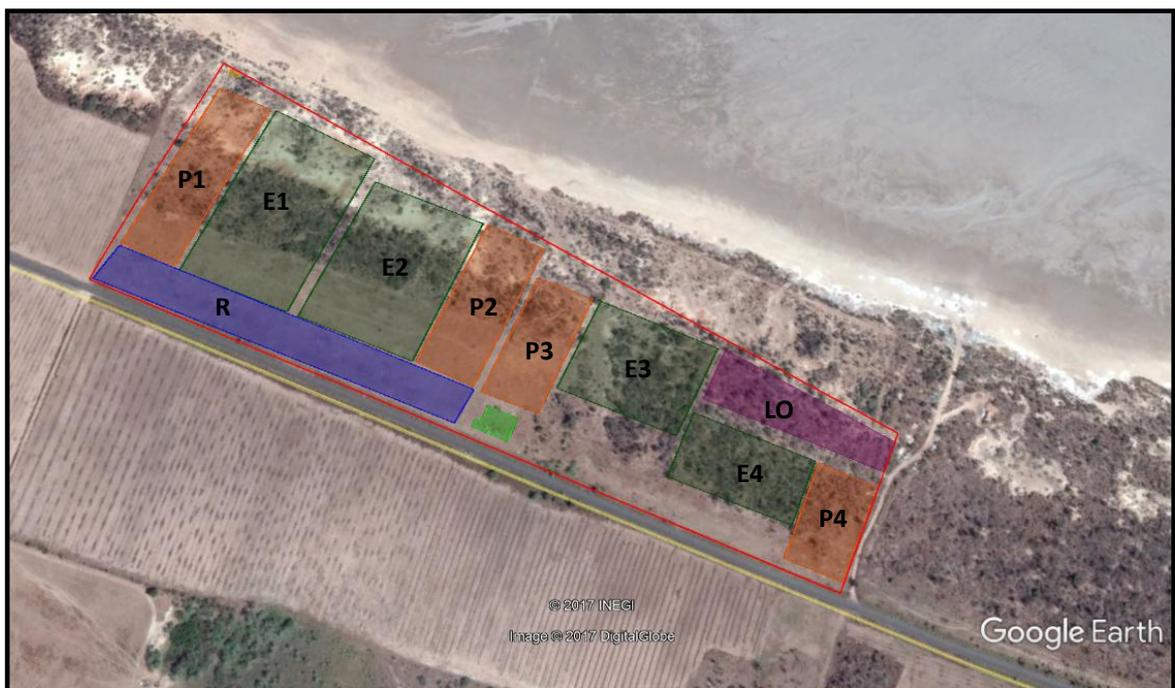
**Figura II.1.** Distribución de áreas en granja de cultivo hiperintensivo de camarón (P: Maternidades y Pre-engordas, E: Engordas, R: Reservorio, LO: Laguna de Oxidación)
