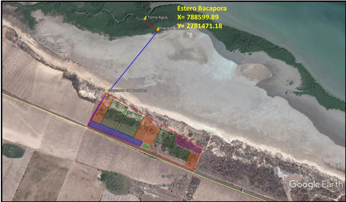
Figura II.2. Punto de extracción de agua y tuberías de distribución en la granja, Polígono (■), tubería de conducción de agua (—)
