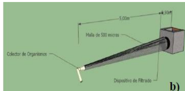
Figura 2.8 Diagrama dispositivo de filtrado y colector de organismos del SEFA.
