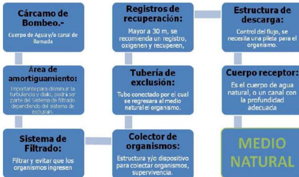
El sistema está comprendido por un área de amortiguamiento, dispositivo de filtrado, colector de organismos, tubos de exclusión registros de recuperación, estructura de descarga y cuerpo receptor.
