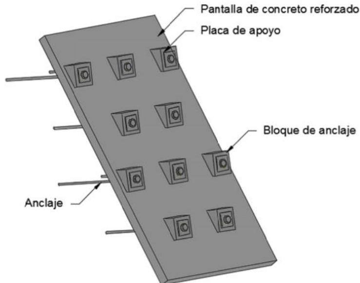
Tanto la pantalla de anclaje como el dado de reacción o bloque de anclaje, deberán diseñarse estructuralmente por especialista.
