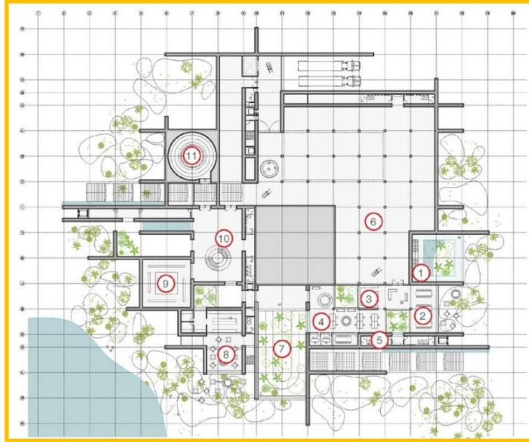
**Figura II.2.-** Niveles y Componentes principales del Acuario del Mar de Cortés (Planta Nivel 0).
