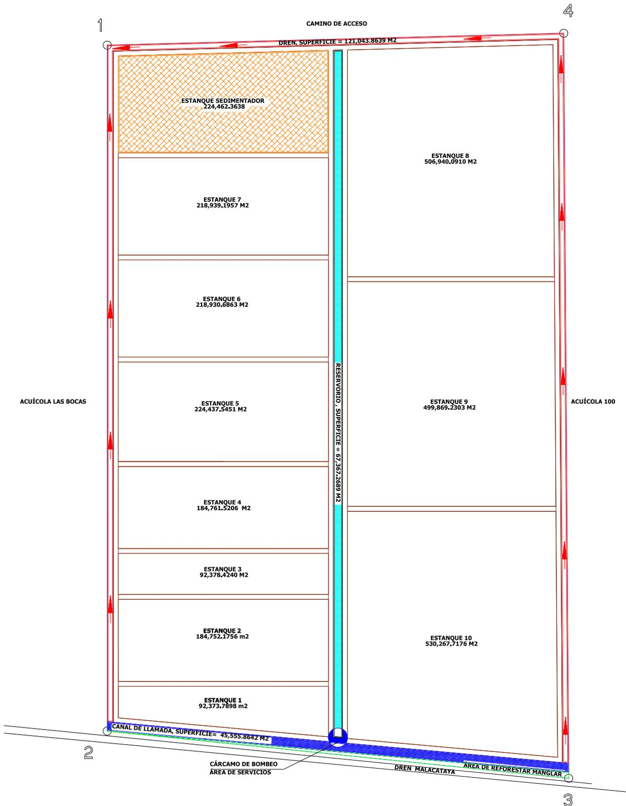
Imagen que muestra la distribución de estanqueria, drenes, reservorio y estanque sedimentación, entre otros componentes.
